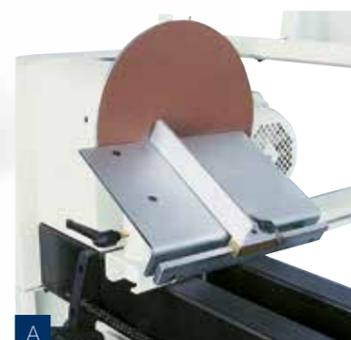
**A) Schleifaggregat**, mit schrägstellbarem Tisch, Anschlag und Schleifscheibe.
