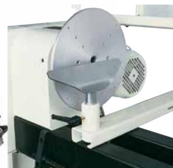
**Planscheibe** mit 300 mm Durchmesser zum Bearbeiten von großen Schalen.
