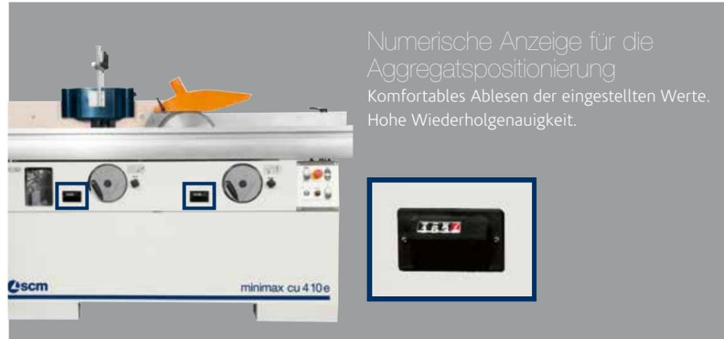
Numerische Anzeige für die Aggregatspositionierung
