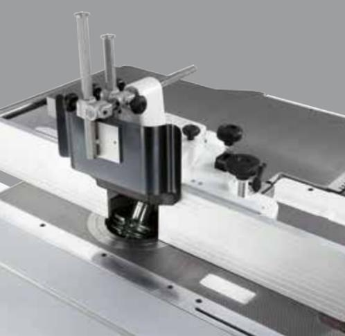
Verstellbarer Fräsanschlag, 3-Fach positionierbar
