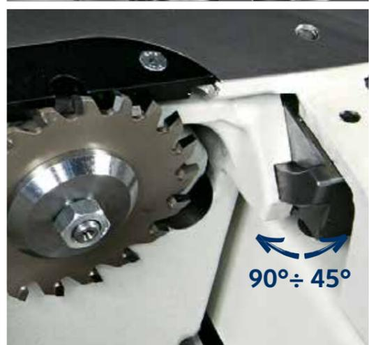
Der Vorritzer mit unabhängigem Motor ist ohne Schlüssel von außen regulierbar und erlaubt schnelle, präzise und spielfreie Positionierungen.
