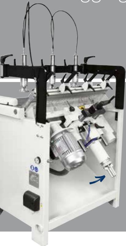
Präzises horizontales, vertikales und 45° Bohren.
