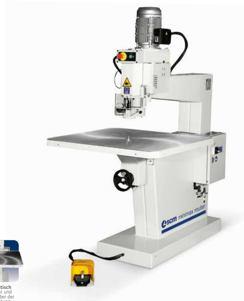
Oberfräse mit pneumatischem Hub des Kopfes für anspruchsvolle Tischlerei- und Handwerksbetriebe.
