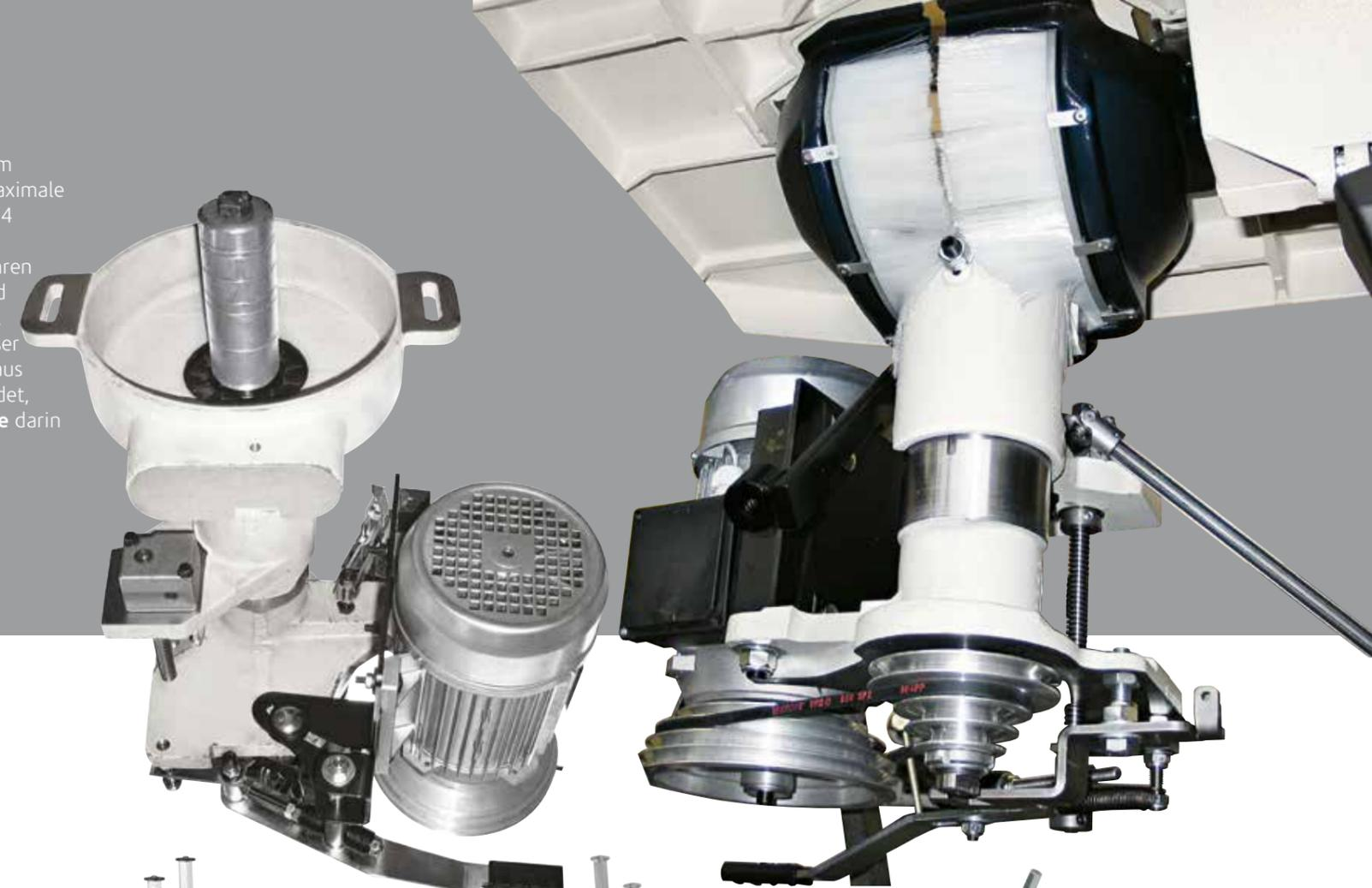
Zwei Vorschubgeschwindigkeiten (6 – 12 m/min) beim Dickenhobeln sind Standard. Bei der cu 410e öffnen sich die Abrichthobeltische zur Seite des Säge-Fräsaggregats. Diese Lösung ist ergonomisch optimal und nimmt am wenigsten Platz weg.
