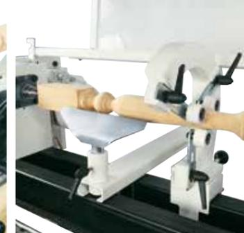
**Feststehende Lünette**, zur Reduzierung der Vibrationen bei langen und dünnen Werkstücken. Die C-förmige Auslegung ermöglicht den Durchlauf eines Handwerkzeugs.
