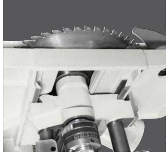
Der Drehzapfen des oszillierenden Körpers mit Durchmesser 120 mm liegt auf einer Zwischenlünette auf dem Untergestell auf: eine verwindungssteife und dauerhaft zuverlässige Lösung.
