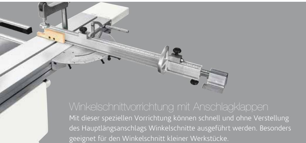
Winkelschnittvorrichtung mit Anschlagklappen
