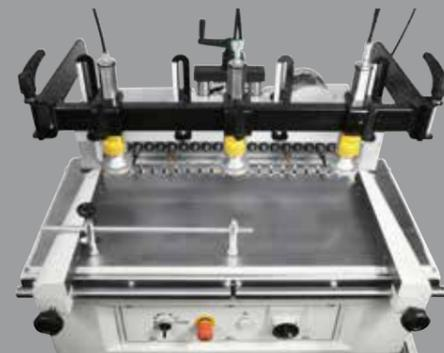
Die Bohrer sind bequem und im Handumdrehen ausgewechselt! Die Maschine ist dafür mit 21 Spindeln mit Schnellverschlüssen ausgestattet.
