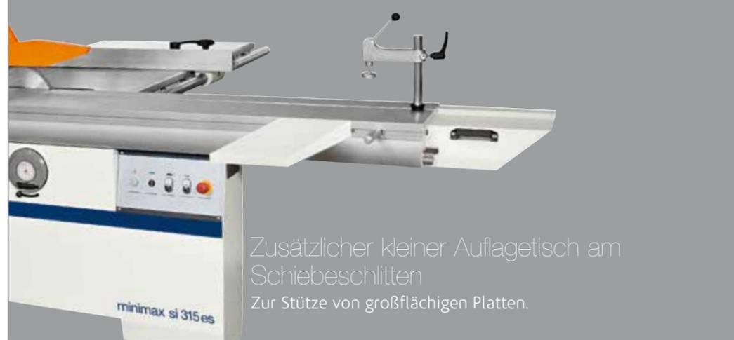
Zusätzlicher kleiner Auflagetisch am Schiebeschlitten
