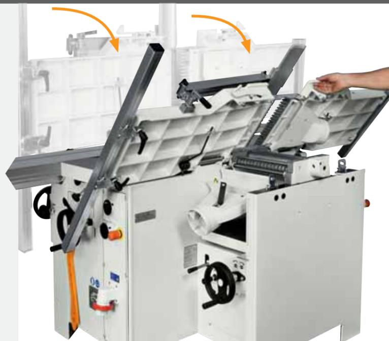
Rigidité absolue des guides de dégau des *fs 30* et *41 classic* en aluminium extrudé d'une longueur respective de 1300 mm et 1670 mm.
