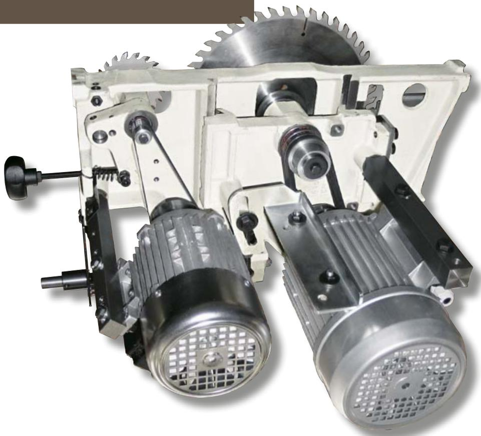
La structure robuste en fonte avec système à queue d'aronde permet le soulèvement du groupe scie avec une extrême souplesse
