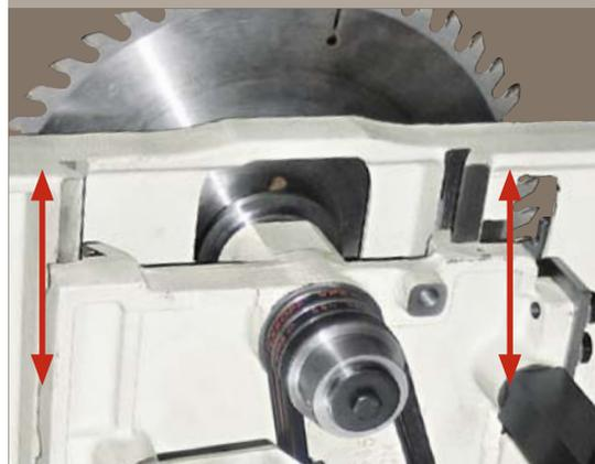
Le système est protégé par un convoyeur de sciures qui peut être relié directement à l'aspiration. Il évite ainsi que les poussières et les déchets ne pénètrent à l'intérieur de la machine.
