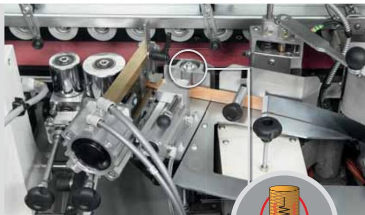
Le rouleau encolleur avec résistance interne garantit une application de la colle constante à la température maximale de travail même sur panneaux avec petites et grandes dimensions.
